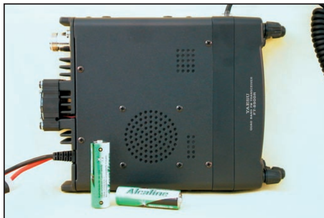
Cette vue de dessus montre, grâce aux piles donnant l'échelle, l'encombrement du FT-8900R.
