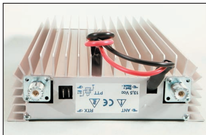
3 - Une vue du panneau arrière; notez les deux broches de télécommande.
