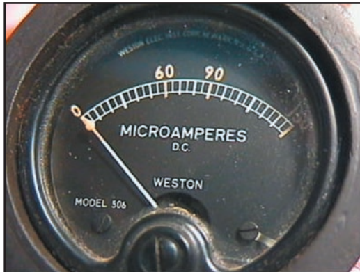
Figure 4: Un galvanomètre de l'ancien temps.
