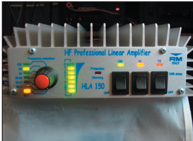
4 - Toutes LED allumées, le HLA 150 en fonctionnement.
