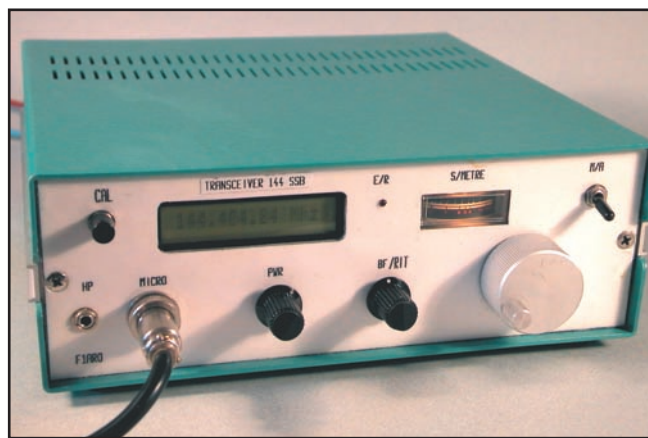
Le transceiver 144 MHz de l'auteur, intégrant le DDS décrit dans l'article.
