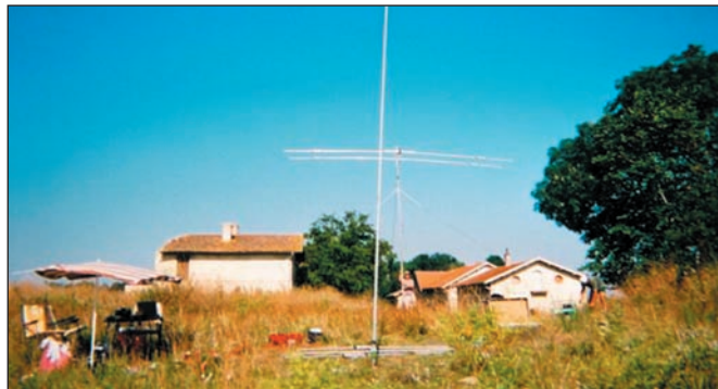
5 - L'antenne verticale 40 m et, derrière, la FB23
