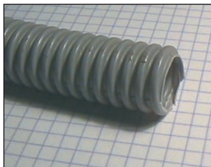
Figure 2: Gaine électrique annelée pour faire des supports.
