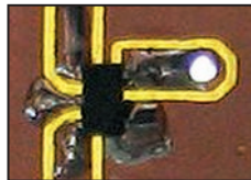
Figure 11: La soudure du LTC1799!
