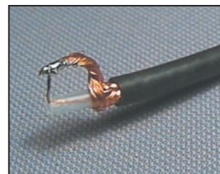
Photo 1 : La ligne est en court-circuit à un bout.
