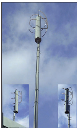
Fig. 11 - Vue générale des antennes Quadrifillar Helix (GOHPO).
