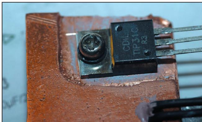
Figure 11 - Montage du TIP31.
