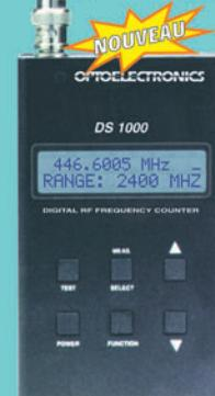
**DS-1000 - Fréquence-mètre digital et analogique 10 MHz à 2,6 GHz.** Permet la capture des fréquences selon les protocoles APCO 25, Tetrapol, TDMA, GSM, On/Off Keying et fréquences pulsées (500 µs mini). Fonction mesureur de champ (-45 à -5 dBm). Sortie C15 permettant d'accorder automatiquement un récepteur compatible sur la fréquence capturée (uniquement analogique). 1000 mémoires pouvant être chargées dans un PC via la sortie RS-232.
