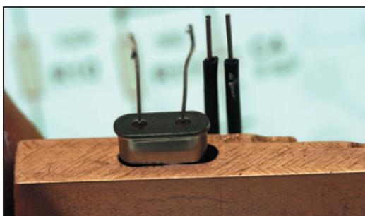
Figure 9 - Mise en place du quartz.
