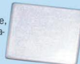
Cette antenne directive patch offre un gain de 8,5 dB. Elle s'utilise en réception aussi bien qu'en émission et permet d'augmenter considérablement la portée des dispositifs RTX travaillant sur des fréquences. Ouverture angulaire : 70° (horizontale), 65° (verticale). Gain : 8,5 dB. Câble de connexion : RG58. Connecteur : SMA. Impédance : 50 Ω. Dim. : 54 x 120 x 123 mm. Poids : 260 g.
