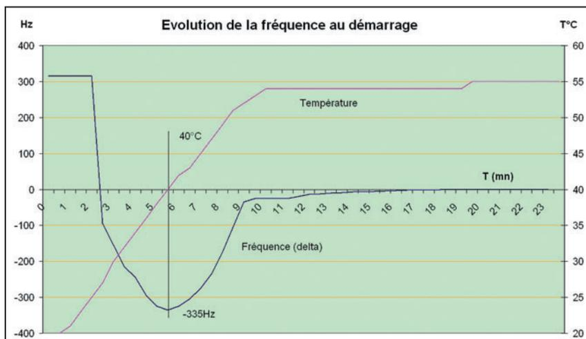
Figure 13 - Évolution de la fréquence au démarrage.
