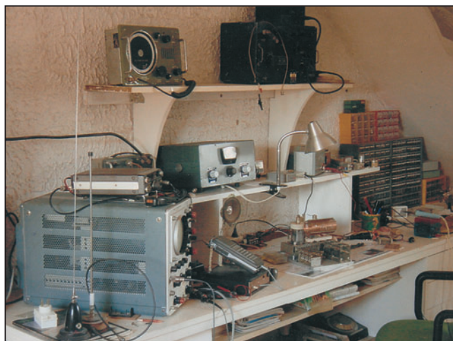
2 - Sur l'étagère, un autre linéaire, équipé de 4 x 807 fonctionnant en classe AB1.
