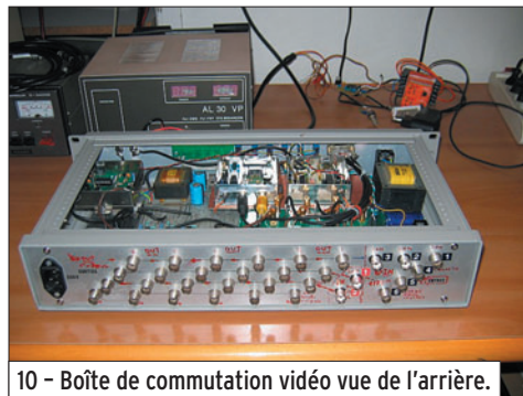
10 - Boîte de commutation vidéo vue de l'arrière.
