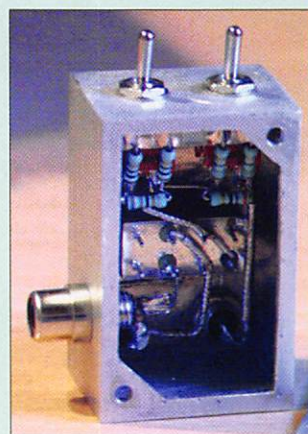
9 - Le module atténuateur avec coupleur hybride pour récepteur auxiliaire.
