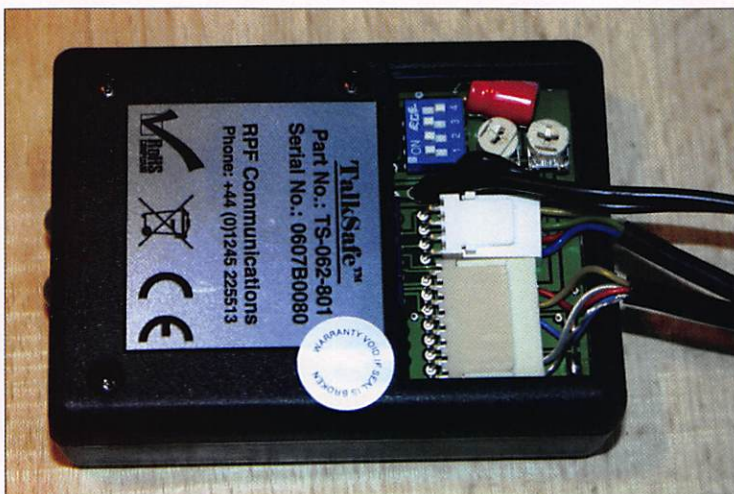
2 - Le dessous du boîtier avec les connecteurs et les réglages.
