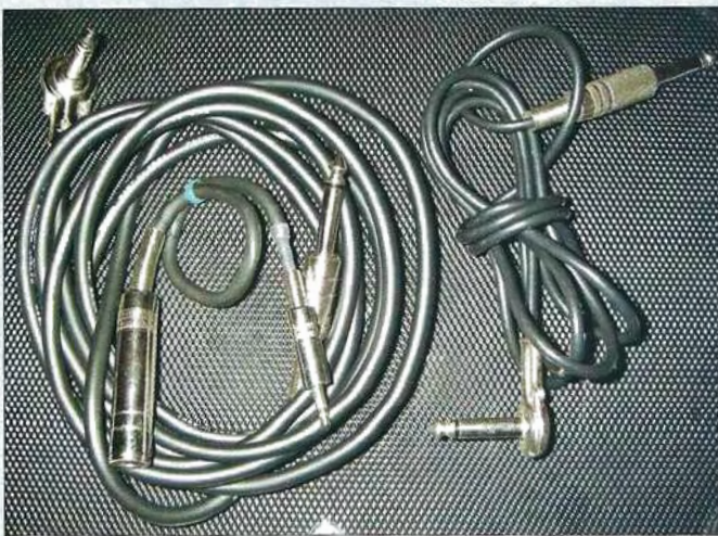
10 - Les liaisons, en câble blindé.
