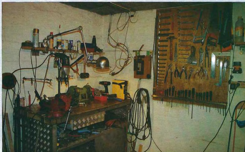
Vue partielle de l'atelier de l'auteur. La structure de l'établi est en cornières inox, ainsi que la visserie d'assemblage, le reste en plaques d'alu, le tout est facilement démontable.
