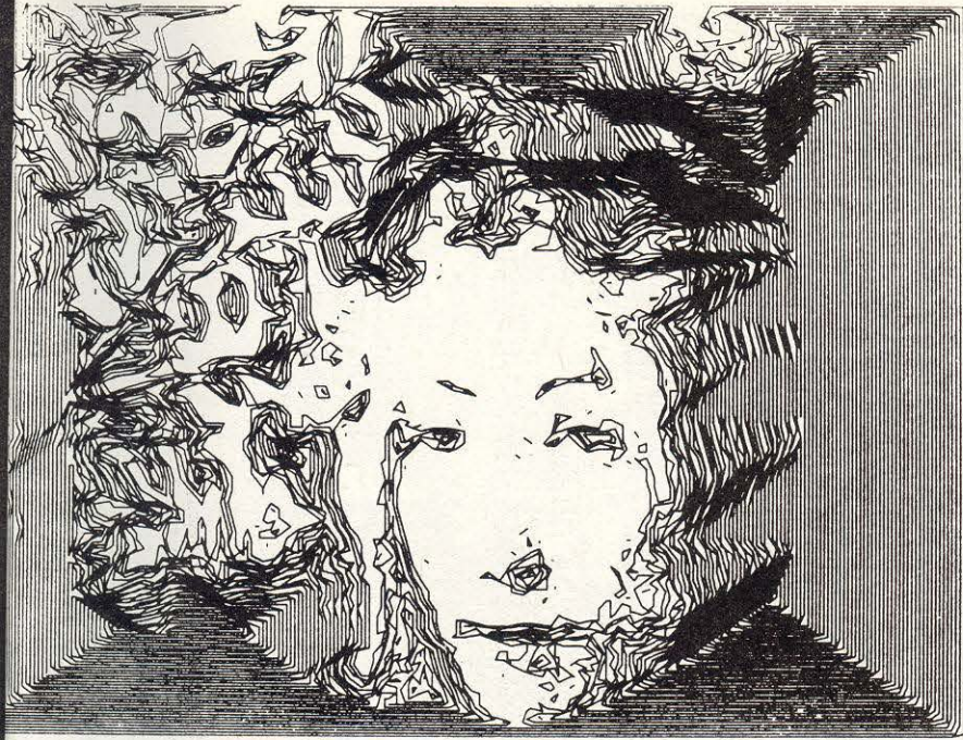
Fig. 2. — Un extracteur de contours est disponible. Après chaque extraction, le contour ainsi obtenu est « soustrait » de l'image, et ceci jusqu'à l'extinction de l'image.
