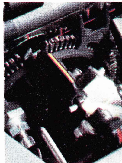
Une tête d'impression « marguerite » et, ci-dessus, gros plan sur le marteau de frappe. (Doc. Xerox).
