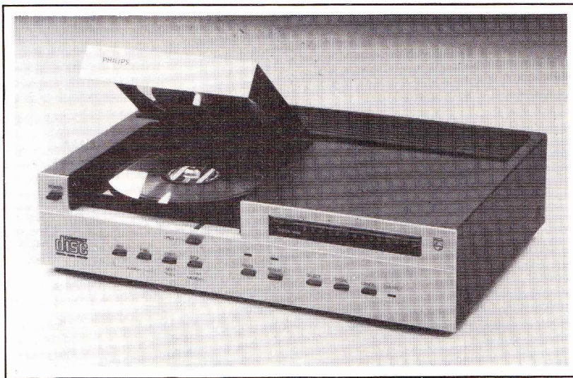
Photo A. – Le Compact Disc digital audio et son disque de 12 cm. Notez la simplicité de sa face avant.
