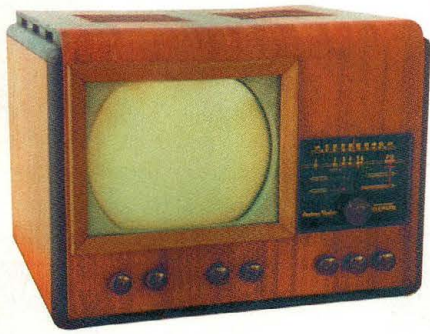
5- TV Andrea Radio Télévision N.Y. Modèle UK12. Uniquement VHF. 28 Tubes sphériques.
