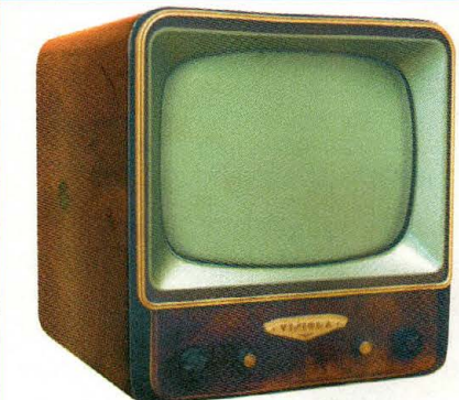
16- Visiola VT330. Tube à rayons cathodiques de 17". 18 Lampes, 2 diodes à cristal, 9 canaux.
