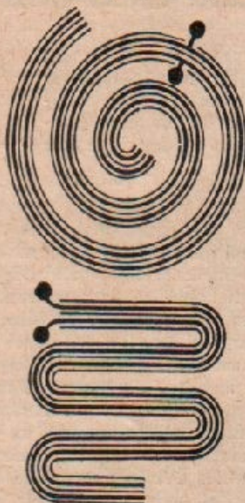
FIG. 2. — Deux modèles de condensateurs non inductifs : pliage en accordéon et prises médianes.
