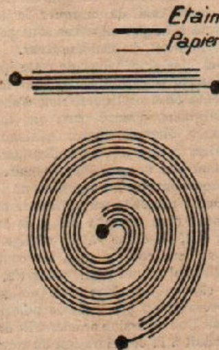
FIG. 1. — Fabrication d'un condensateur au papier. Les bandes d'étain séparées par une feuille de papier et mises entre deux autres feuilles de papier, sont enroulées sur elles-mêmes.
