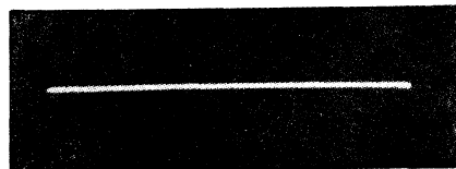
Fig. 6. — Ligne de référence commune à la sortie, lorsque la tension d'écran est équilibrée.
