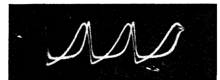
Fig. 8. — Oscillogrammes correspondant aux deux entrées lorsque la ligne de référence est commune.
