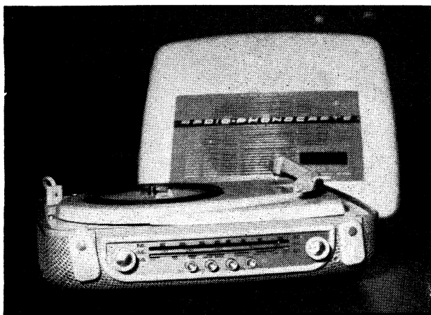
A gauche : « Radio-Phonocapte » à 8 transistors. Puissance 0,8 W (Célar).
