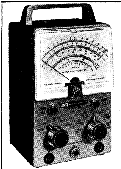
Voltohmètre électronique à tubes IM 18. Tensions (continues et alternatives) : 7 calibres (1,5 - 5 - 15 - 50 - 150 - 500 - 1 500 V). Impédance d'entrée : 11 M \Omega (continu) ; 1 M \Omega -30 pF (alternatif). Utilisable entre 25 Hz et 1 MHz. Résistances : 7 calibres avec 10 - 100 - 1 000 \Omega - 10 - 100 k \Omega - 1 - 10 M \Omega au milieu de l'échelle. Alimentation sur secteur 127/220 V. (7)
