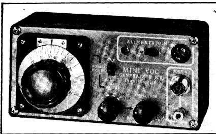
Générateur B.F. Mini-VOC. Entièrement transistorisé, délivre un signal sinusoïdal ou rectangulaire de 10 Hz à 100 kHz (4 gammes). Tension de sortie réglable par potentiomètre de 0 à 6 V c. à c., sur 600 \Omega . Distorsion : 0,3 % de 200 Hz à 100 kHz. Temps de montée en rectangulaires : 0,2 \mu s. Dimensions : 190 \times 95 \times 100 mm. Poids : 850 g. (20)
