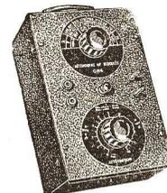
**VOLTMÈTRE ÉLECTRONIQUE VE 8** pour mesure, à haute impédance d'entrée des tensions cont. et alt. BF et HF (de 15 c/s à 50 Mc/s) de 0 à 10 V, 50 V, 200 V et 500 V et des résistances élevées de 0 à 200 mégohms. Prix. .... **9.880**
