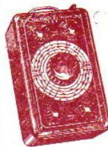
Hétérodyne de service la plus complète sous le plus petit volume, couvrant, « sans trous », de 100 Kc à 32 Mc (3.000 à 9,35 m) en 6 gammes dont une MF étalée. — Précision et stabilité 1 %. Permet d'obtenir : soit la HF pure, soit une BF à 1.000 p/s, soit la HF modulée par la BF. Prise pour modulation extérieure. Prise pour mesure des capacités. Atténuateur double. Fonctionne sur « tous courants » et consomme 20 watts. Coffret aluminium givré. Dim. : 26 x 16 x 10 cm. Poids : 2 kg. **23.920**
