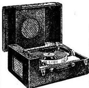
**Partie ampli** : 3 lampes « Rimlock » (EF41, EL41, 3Z41). Puissance de sortie 3 watts. Haut-parleur 17 cm tonical « Audax » inversé, dans couvercle.
