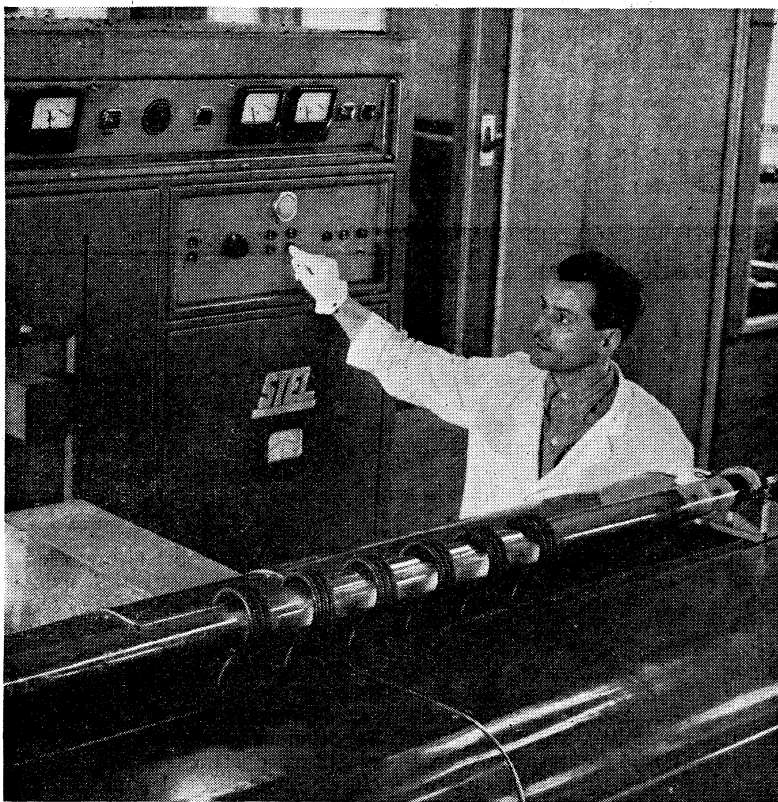
N° 2. — Machine à raffiner physiquement le germanium par « fusion de zone ». Le lingot à purifier est placé dans une nacelle de graphite, à l'intérieur du tube de quartz rempli d'hydrogène pur.
