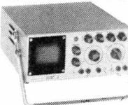
Entièrement transistorisé avec transistors à effets de champ et circuits intégrés. Tube cathodique rond de 7 cm. Bande passante de 0 à 5 MHz (± 3 dB). Alternateur vertical compensé 12 positions. Impédance entrée : 1 MΩ (10 avec sonde), etc. Alimentation secteur 110/220 (100 x 230 x 240). Poids : 3,5 kg.
