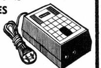
**STOLLE 3406.** Secteur 110/220 V. Sorties en courant continu stabilisé, commutable de 4-5-6-7-5-9 et 12 V par transistor puissance et diode Zener. Débit 400 mA.
