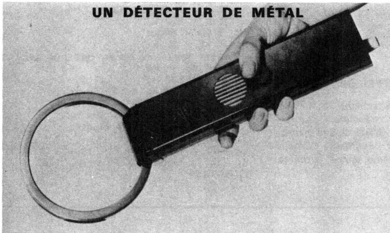
CICOR propose un appareil particulièrement intéressant permettant la détection de tous métaux, magnétiques ou non magnétiques.
