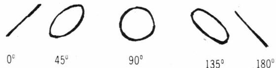
A l'aide d'un tournevis non conducteur, on règle le condensateur ajustable du générateur BF jusqu'à ce qu'une courbe similaire à celle de la figure 2 apparaisse et s'immobilise sur l'écran du tube de l'oscilloscope. Si on règle le générateur sur 50 périodes en utilisant le balayage horizontal à 50 périodes, on doit obtenir l'une des courbes de la figure 3.
