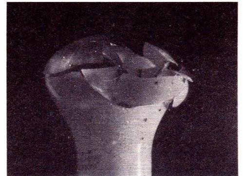
Photographie d'une ampoule éclatant sous l'action d'une bille d'acier, réalisée grâce au retardateur (voir figure 5).
