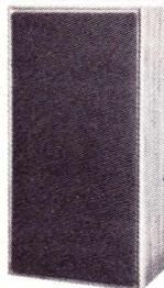
Système basse reflex, puissance de 30 watts. Bande passante de 30 à 20 000 Hz. Système 2 voies. Un haut-parleur 24 GME à très large bande : 12 000 maxwells, noyau 38 mm bague cuivre à flux dirigé. Impédance constante. Diaphragme avec cône pour le haut médium. Un tweeter 7 cm, séparation par filtre condensateur. Dim. 650 x 300 x 195.
