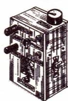
Par l'intermédiaire de cet appareil, lorsqu'on approche ou qu'on touche une plaque métallique quelconque, on déclenche l'action d'un relais à fort pouvoir de coupure. La plaque peut être remplacée par un objet métallique quelconque : poignée de porte, outil, coffret, ap-
