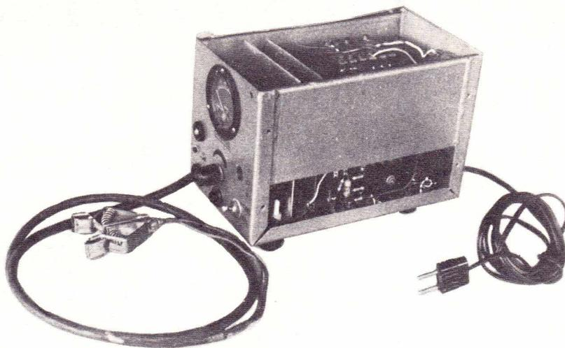
La majorité des chargeurs d'accumulateurs sont établis suivant le principe suivant : un transformateur alimenté sur le réseau débite à son secondaire sur un redresseur à simple ou double alternance. La tension redressée est appliquée à la batterie à travers une résistance limitatrice de courant évitant un débit trop important lorsque la batterie est complètement déchargée.
