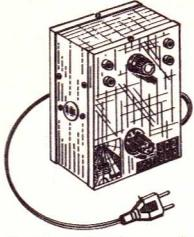
C'est un appareil qui se branche à la sortie d'un amplificateur BF ou d'un récepteur de radio, en dérivation sur le HP. Il commande l'éclairage d'ampoules lumineuses de diverses couleurs (rouge, bleu, jaune...)
