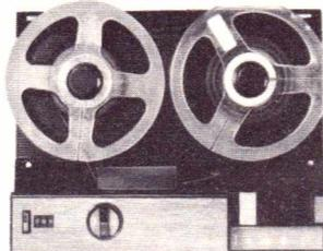
MF : 3 vit. : 4,75 x 9,5 x 19 cm. Bobines 180 mm. Comp'eur. Possibilité 3 têtes Pleurage et scintillement meilleurs que 0,20 % à 9,5 et 0,10 % à 19 cm. Commande par clavier à touches.
