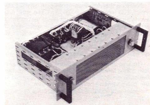
L'alimentation continue régulée qui alimente la lampe de tirage d'une puissance de 1 kW sous 250 volts.
