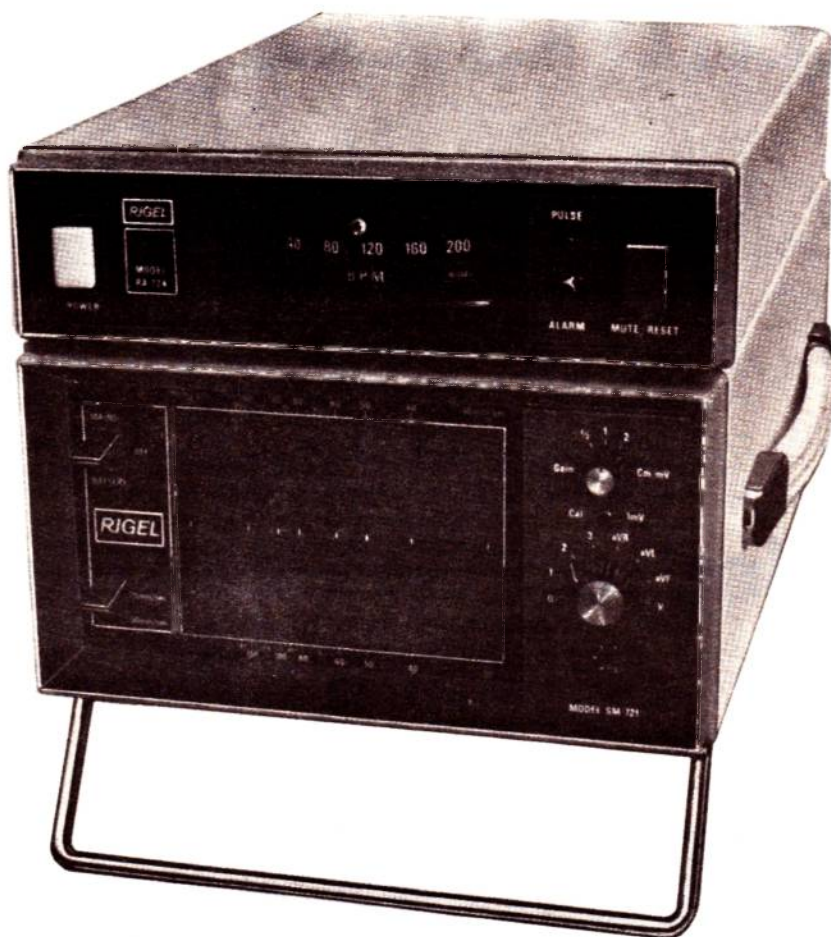
Figure 5 : Un exemple d'ensemble « tête de lit ». La partie inférieure comprend l'oscilloscope une trace et l'amplificateur d'E.C.G. Le cardi tachymètre est contenu dans le boîtier supérieur, muni de systèmes d'alarme de fréquence cardiaque excessive ou insuffisante.
