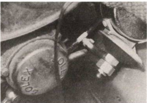
La tubulure d'admission avant adaptation : il suffit de couper le tube plastique et d'y introduire une dérivation en T pour tuyau à air d'aquarium.
