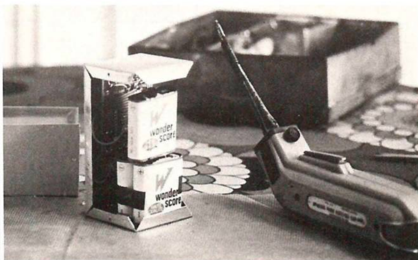
— Le boîtier une fois plié avec le circuit imprimé et les piles 4,5 V assurant l'alimentation de l'ensemble.
