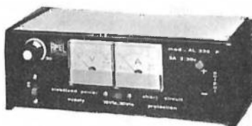
AL1P5 Sortie réglable 15 V courant 5 A
