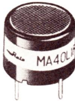
Un transducteur ultrasonique type MA 40 LIR/S STETTNER utilisé dans cette réalisation.
