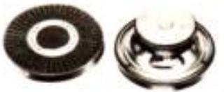
REF. ES-80 - Haut perforé hi-fi, bande passante 50 à 14 500 Hz, flux magnétique 15 000 gauss membrane renforcée avec cône d'alumine impéd. 4 ohms, puissance max. admissible 20 WATTS, diamètre 185 mm, profondeur d'encastrement 50 mm, grille décor amovible
