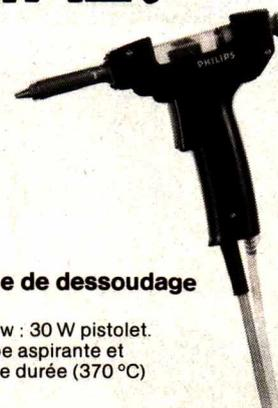
Un fer thermostaté intégré sûr et précis et un ensemble de dessoudage efficace et très maniable : la sécurité de vos circuits multicouches est assurée.
