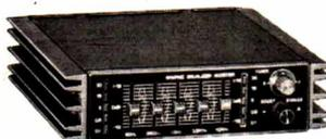
Puissance tot. 60 WATTS music. (2 x 30 W), réponse en fréq. 30 à 30 000 Hz, rapport S/B > 58 dB, égalizer 5 bandes (60 - 250 Hz - 1 - 3.5 - 10 KHz), réglage ± 12 dB sur chaque bande, commutateur (by-pass) pour écoute avec ou sans égalizer, 4 sorties H.P. 4 à 8 ohms, balance avant/arrière, alim. 12 volts (- à la masse), L. 157, H. 41, P. 155 mm.
