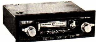
Récepteur GO - PO - FM mono et stéréo avec C.A.F., 5 stations préréglables (2 en GO - 1 en PO - 2 en FM), Lecteur toutes cassettes (Fe ou Cr), AVANCE et RETOUR rapide (blocable) de la bande, EJECTION automatique fin de bande, commandes de volume, tonalité, balance stéréo, commutateur mono/stéréo, puissance totale 12 WATTS music. (2 x 6 W), impéd. H.P. 4 à 8 ohms, alim. 12 volts (- à la masse), L. 180, H. 50, P. 160 mm.
