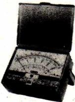
**Centrad 819** 20000 Ohms/V = , 4000 Ohms/V ~ . 80 gammes de mesures, Cadran panoramique avec miroir de parallaxe. Dim. 130 x 95 x 35 mm, poids 300 g, livré avec cadran, pile et étui.
