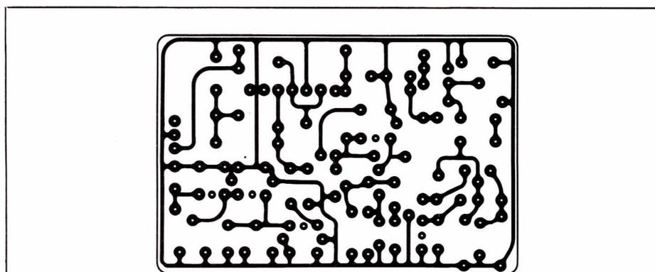
Figure 2 : Tracé du circuit imprimé.
