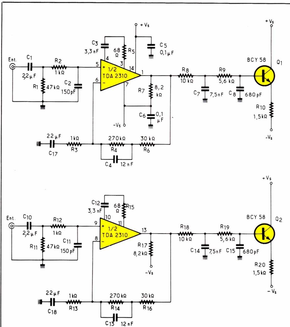
Figure 10 : Schéma de principe du préampli RIAA « 2310 ».
