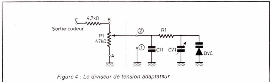
Figure 4 : Le diviseur de tension adaptateur
