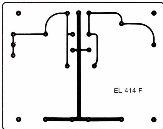
Figure 26 : Alimentation positive, tracé du circuit.
