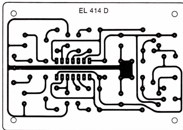
Figure 20 : Carte adaptateur d'impédance « 2310 » tracé du circuit.
