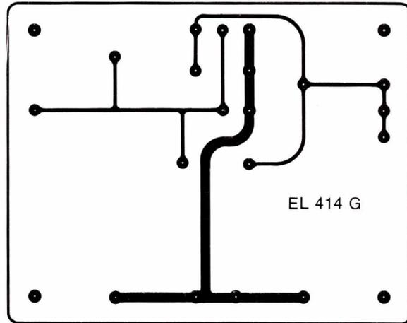
Figure 29 : Alimentation négative, tracé du circuit.
