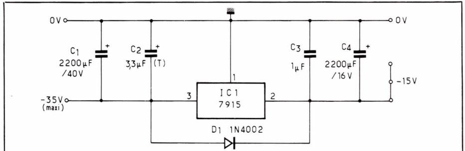
Figure 28 : Schéma de l'alimentation négative.
