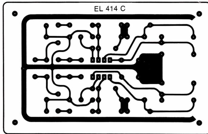
Figure 17 : RIAA FET tracé du circuit imprimé.
