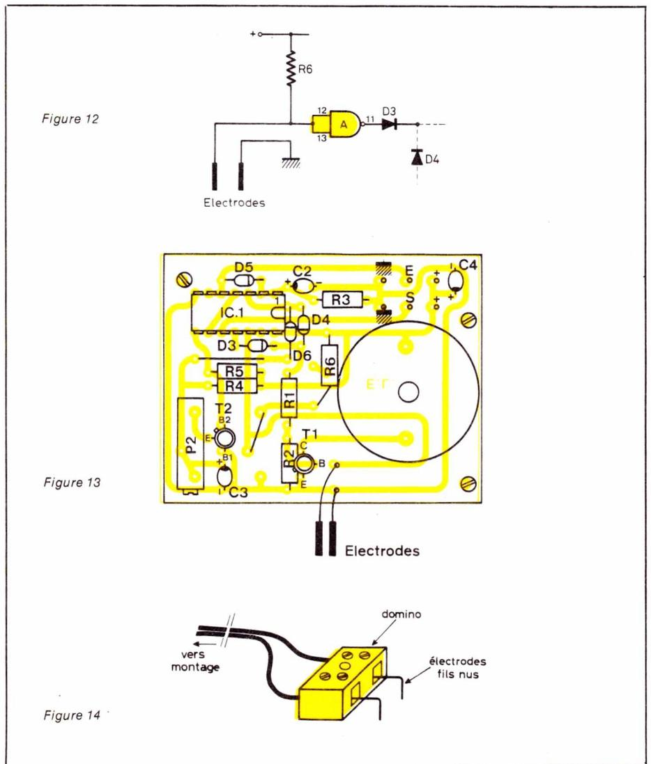
En jouant sur P1, rechercher le seuil de déclenchement ou d'arrêt du buzzer, régler juste au seuil pour couper le son. Le détecteur de tension est donc réglé ; dès que la tension de l'alimentation du récepteur descendra en-dessous de 4,5 V l'alarme se déclenche.
