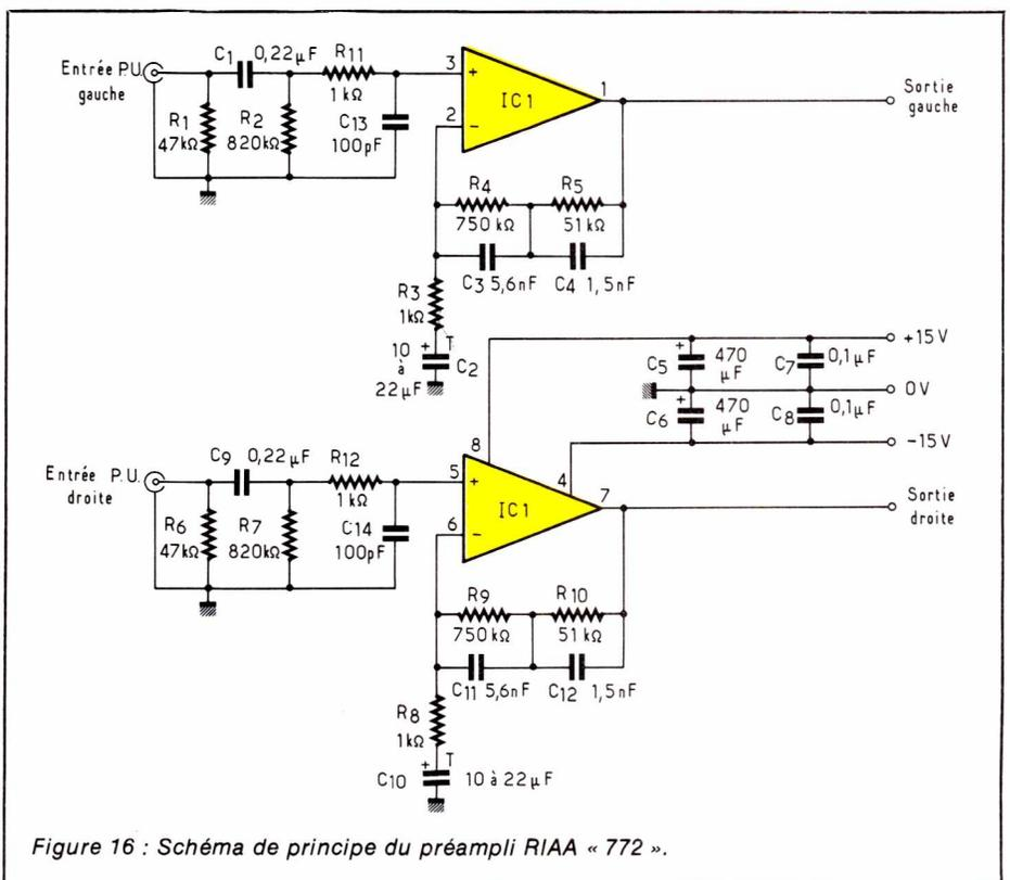
Figure 16 : Schéma de principe du préampli RIAA « 772 ».
