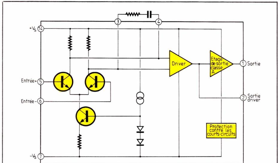
Figure 4 : Schéma interne « résumé » du TDA 2310 SGS.
