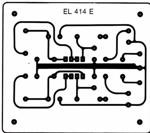
Figure 23 : Carte adaptateur « 772 » tracé du circuit imprimé.
