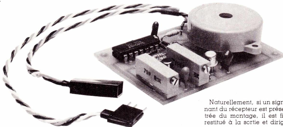
Naturellement, si un signal provenant du récepteur est présent à l'entrée du montage, il est fidèlement restitué à la sortie et dirigé vers le servo.
