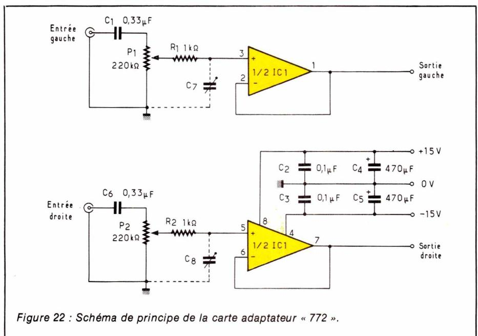
Figure 22 : Schéma de principe de la carte adaptateur « 772 ».
