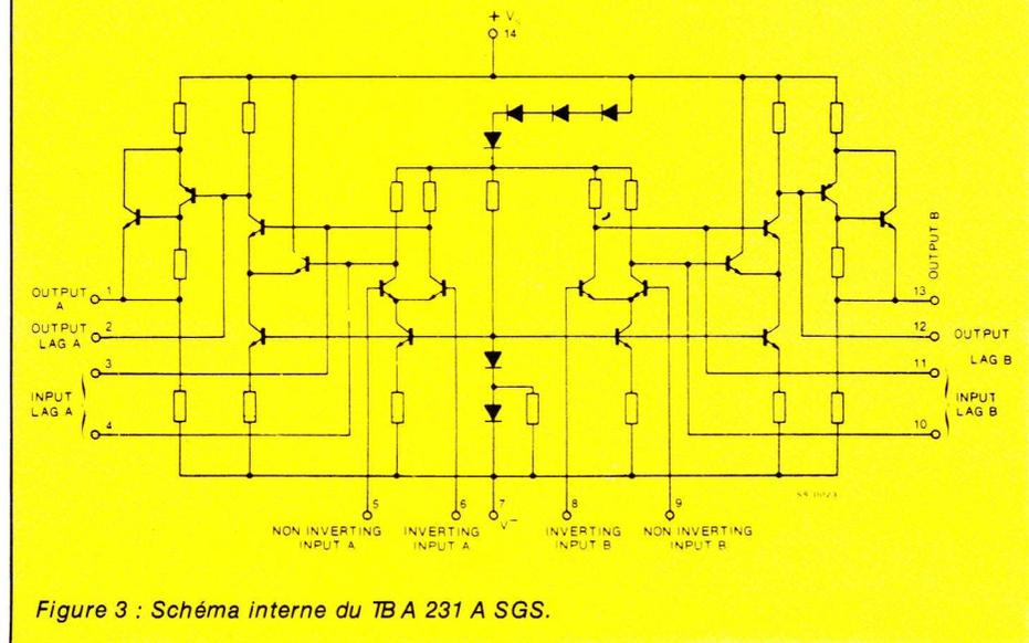
Figure 3 : Schéma interne du TBA 231 A SGS.
