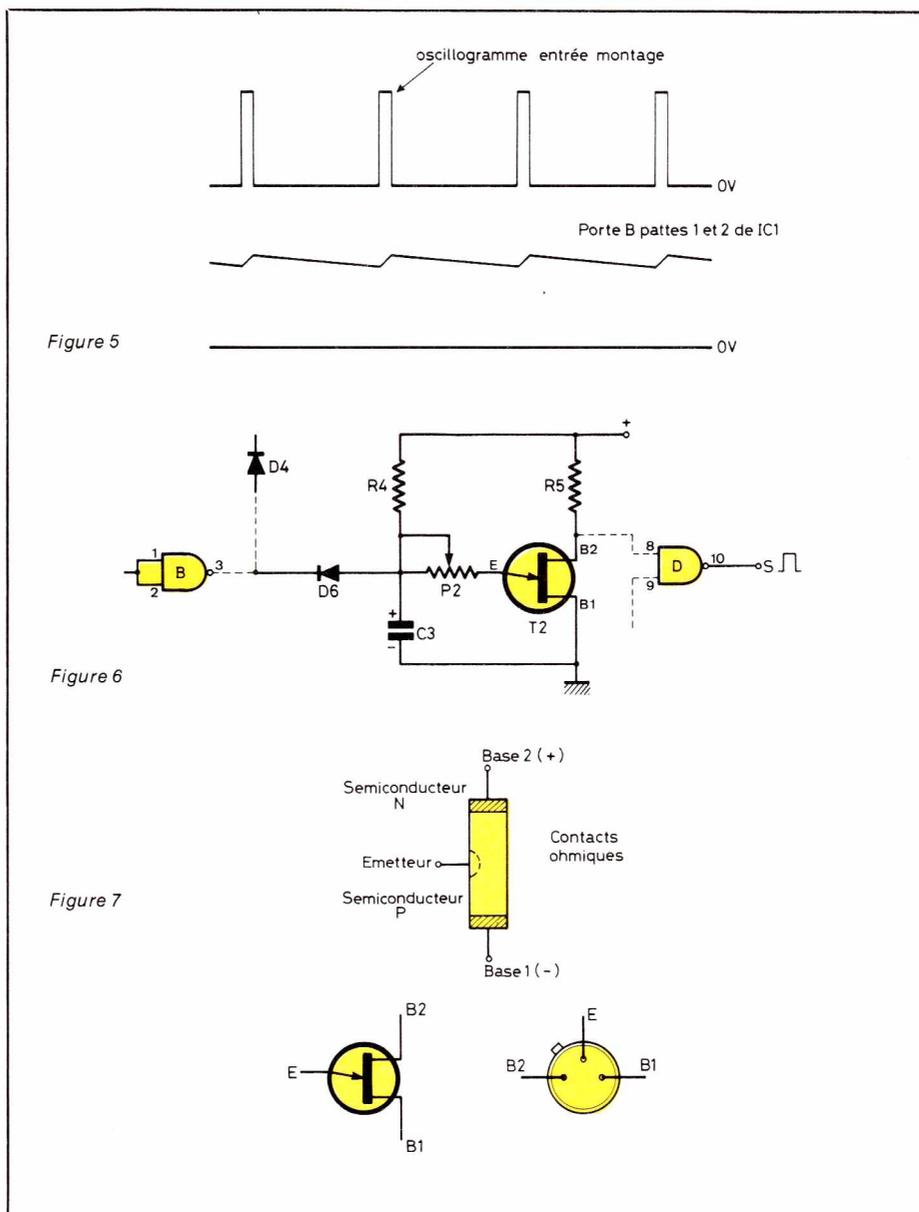
sions à l'entrée du circuit,  $C_2$  reste chargé à une valeur moyenne supérieure au seuil de basculement de la porte B (voir oscillogramme de la figure 5). Si le train d'impulsion disparaît, le condensateur  $C_2$  se décharge complètement dans  $R_3$ , le seuil de basculement est atteint, la sortie 3 de  $IC_1$  passe à 1. A travers  $D_4$  et le pont  $R_1$ ,  $R_2$ , la tension atteint la base de  $T_1$  qui se sature, entraînant le retentissement du buzzer.
