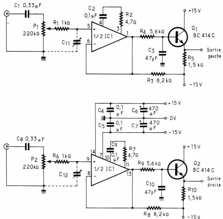
Figure 19 : Schéma de principe du préampli adaptateur « 2310 ».
