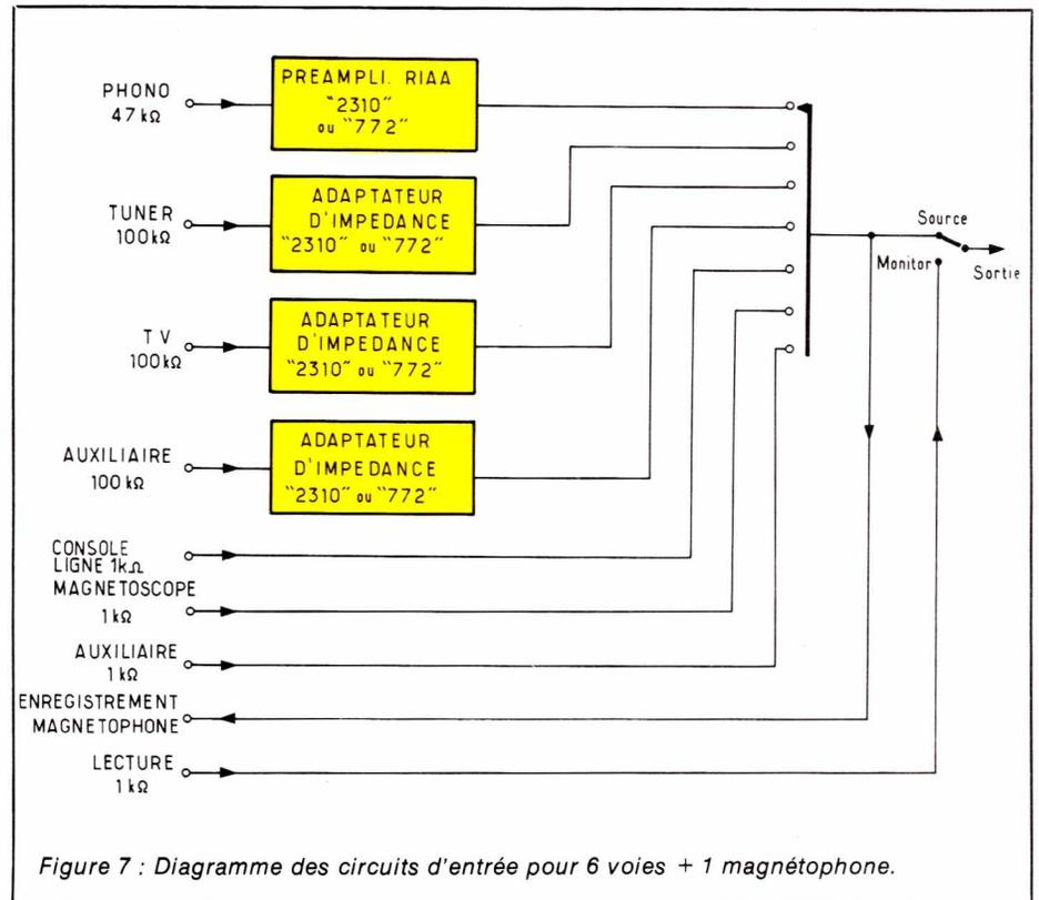
Figure 7 : Diagramme des circuits d'entrée pour 6 voies + 1 magnétophone.
