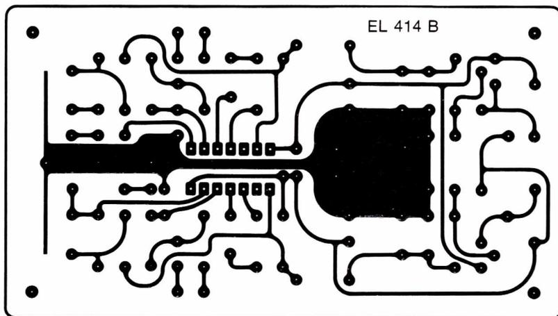
Figure 11 : Préampli phono 2310 tracé du circuit.
