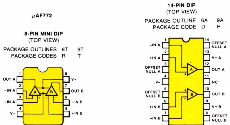
Figure 6 bis : B rochage des amplis-op doubles (vue de dessus).
