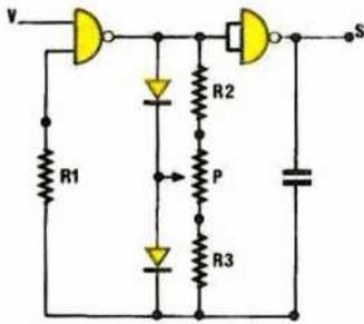
Figure 2g: Oscillateur à portes NAND avec entrée validation et réglage du rapport cyclique.  $V = 1$  oscillation possible  $V = 0$  oscillateur bloqué
