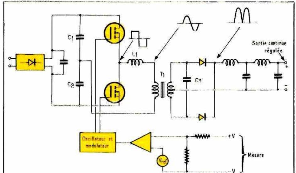
Figure 6: Convertisseur en demi-pont avec modulation de fréquence.
