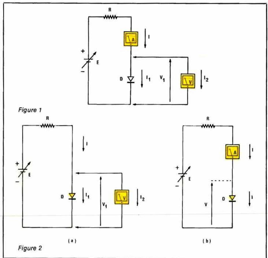
bite, dans l'ensemble, un courant d'intensité  $I$ , dont on limite le maximum, pour protéger la diode, à l'aide de la résistance  $R$ .
