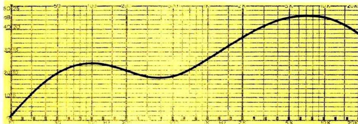
Figure 6 : Courbe de réponse avec correction Max.
