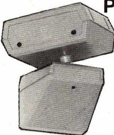
Insensible aux interférences externes. Il est insensible également à quelconque types de vibrations et aux lampes fluorescentes. Contrôle : LED vert, sert à déterminer la sensibilité et la portée du radar ; LED rouge, mémorise une éventuelle alarme. Portée 2 à 30 m. Boîtier autoprotégé orientable à 360°. Angle d'utilisation 120°. Fréquence émission 9.9 GHz. Alimentation de 10,5 V cc à 15 V cc. Switch d'autoprotection IA sous 24 V cc. Consommation en veille 20 mA.
