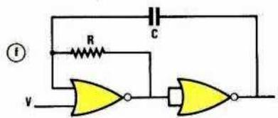
Figure 2f: Oscillateur à 2 portes NOR avec entrée de validation
