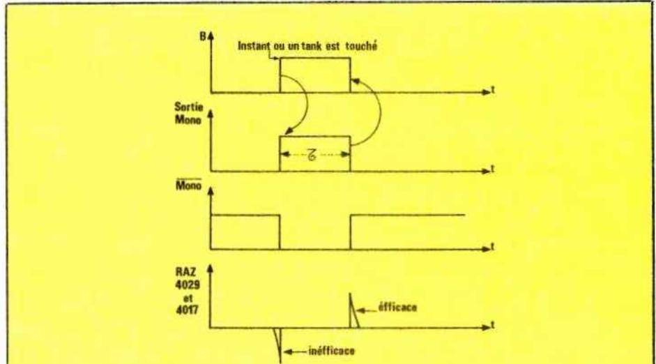
Figure 6: La durée de l'état de la sortie B est fixée par la durée  $\delta$  constante du monostable.
