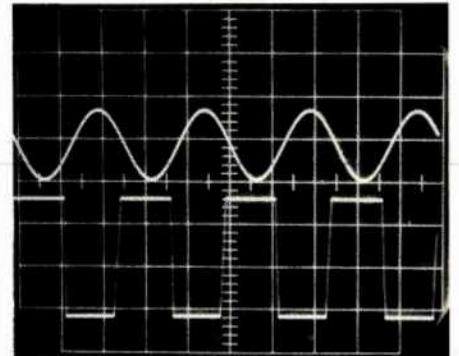
Photo 4 : Signal A : Entrée. Signal B : En mélangeant signal distordu et signal direct tout en jouant sur les corrections on peut obtenir toutes formes de courbes.
