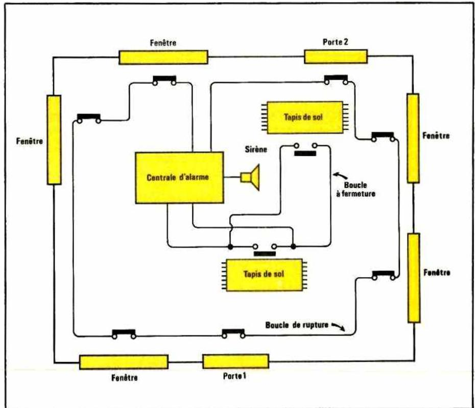
Figure 2: Principe d'une protection périphérique.
