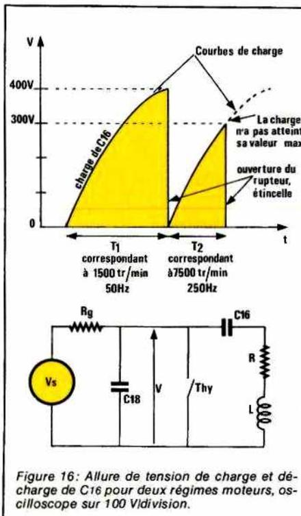
Figure 16: Allure de tension de charge et décharge de C16 pour deux régimes moteurs, oscilloscope sur 100 V/division.
