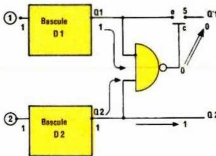
Figure 10: Grâce à la porte NAND connectée aux deux sorties Q<sub>1</sub> et Q<sub>2</sub> et à l'interrupteur électronique, la sortie Q<sub>2</sub> a priorité sur la sortie Q<sub>1</sub> si les informations de commande 1 et 2 arrivent simultanément.
