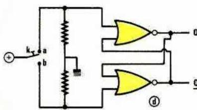
Figure 2d: Si K passe en a Q passe à 0 Q̄ passe à 1
