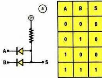
Figure 2a: Fonction ET à diodes
