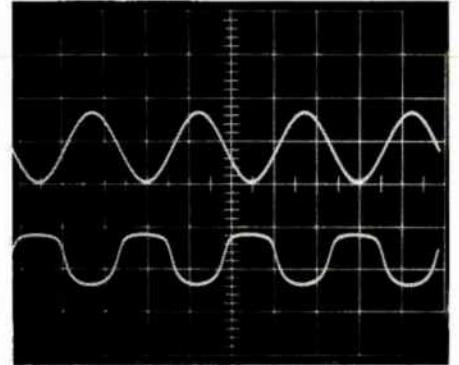
Photo 3 : Signal A : Entrée. Signal B : Sortie saturée par la correction aigüe, comparer la raideur des flancs et la forme des paliers avec 2.
