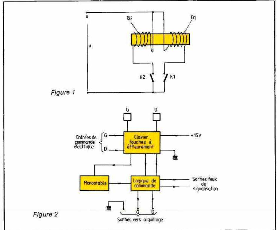
Pour nous résumer, toute action, même fugitive, sur le contact D ou sur l'entrée E<sub>D</sub> fera basculer la sortie repérée A au niveau haut. De même, toute action sur le contact G (ou sur E<sub>G</sub>) fera basculer la sortie repérée B au niveau haut.
