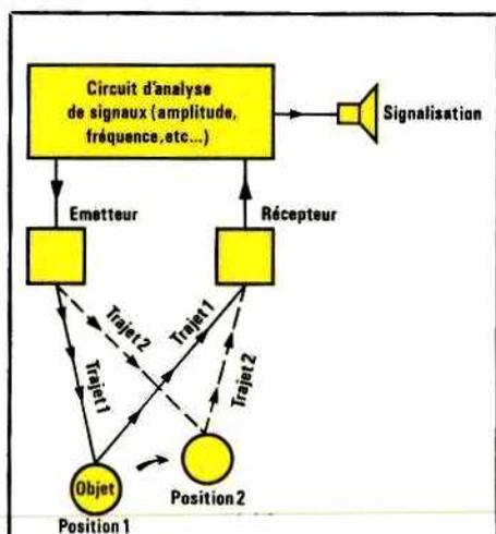
Figure 3: Principe d'une alarme volumétrique.
