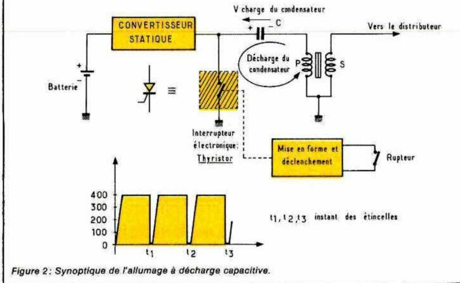
Figure 2: Synoptique de l'allumage à décharge capacitive.
