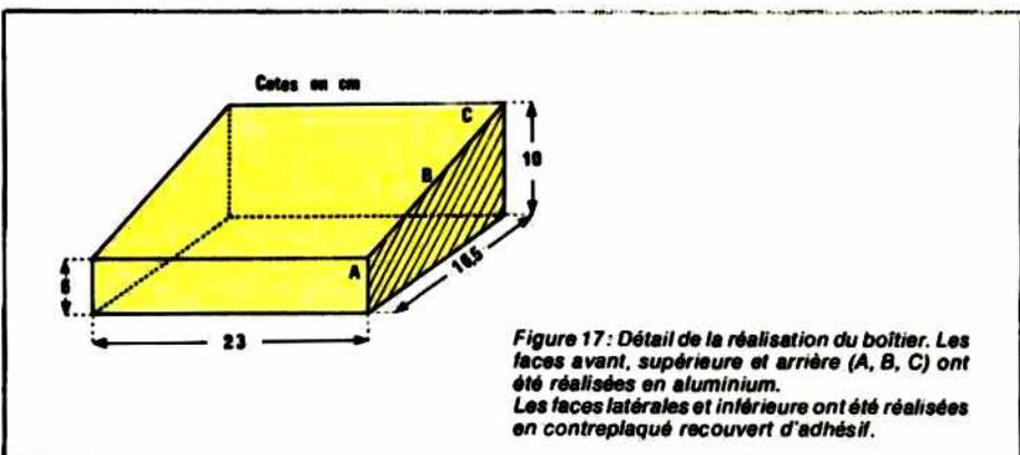
Figure 17 : Détail de la réalisation du boîtier. Les faces avant, supérieure et arrière (A, B, C) ont été réalisées en aluminium. Les faces latérales et inférieure ont été réalisées en contreplaqué recouvert d'adhésif.
