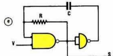
Figure 2e: Oscillateur à 2 portes NAND avec entrée de validation
