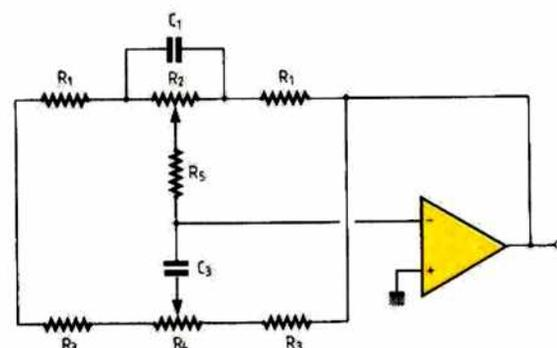
Figure 5 : Schéma de principe du Baxendall.
