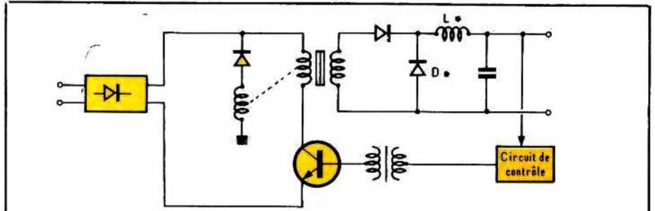
Figure 3: Convertisseur simple alternance, avec modulation de largeur d'impulsion. Pour les éléments notés d'un astérisque, voir le texte.
