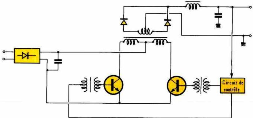
Figure 4: Convertisseur en pont avec modulation de largeur d'impulsion.
