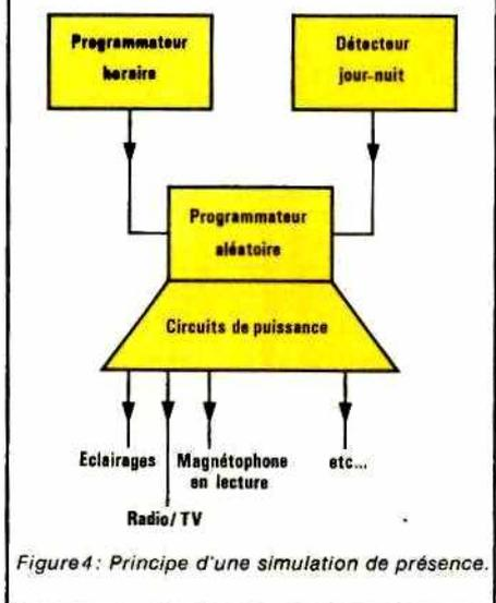
Figure 4: Principe d'une simulation de présence.
