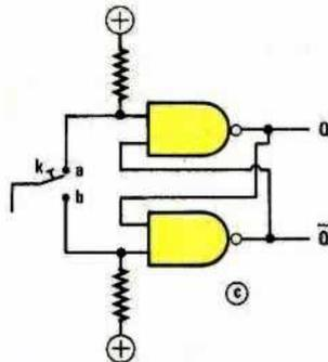
Figure 2c: Si K passe en a Q passe à 1 Q̄ passe à 0
