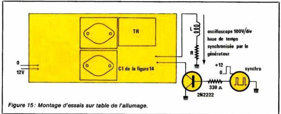
Figure 15: Montage d'essais sur table de l'allumage.
