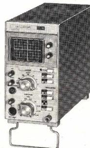
**DÉVIATION VERTICALE** : simple trace, bande passante du DC à 10 Mhz, temps de montée 35 nano-S, atténuateur 10 positions (10 mV/div. à 5 V/division) impéd. d'entrée directe avec sonde 1/1 : 1 Mégohm/40 pF, et 10 Mégohms/25 pF avec sonde 1/10.
