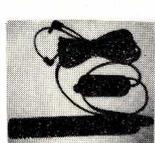
**ELA-18 Microphone AgFa** micro pour paroles. Avec capsule condensateur. Interrupteur M/A sur le câble et un inverseur pour High-LOW-Mediums (Filtre). Avec 1 fiche Jack pour la M/A et 1 fiche Jack pour le signal. La pile de 1,5 V (Mignon) se place dans le corps du micro. Dimensions: L = 170 x Ø = 25 mm
