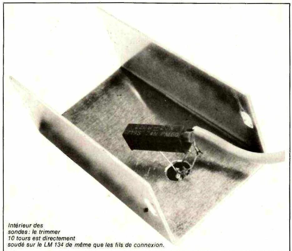
Intérieur des sondes : le trimmer 10 tours est directement soudé sur le LM 134 de même que les fils de connexion.
