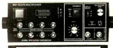
La bande passante s'étend de 0 à 12 MHz à  $-1\text{ dB}$  et 20 MHz à  $-3\text{ dB}$ .
