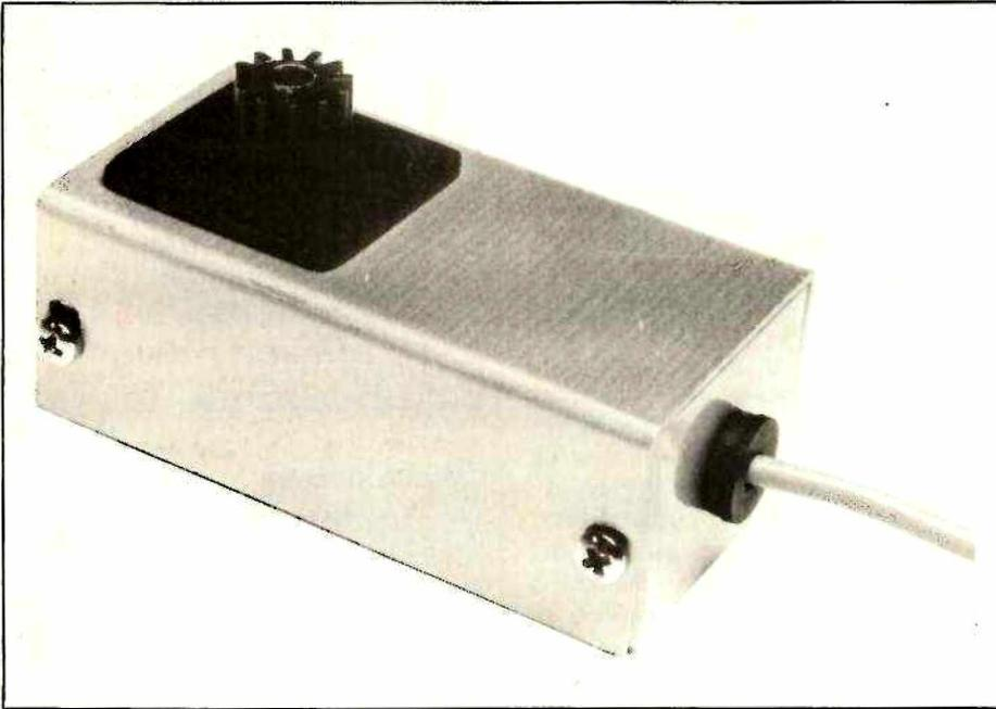
la sonde intérieure la version LM 334, moins chère, convient (plage de 0 °C à 70 °C). Nous avons doté nos deux sondes (identiques) d'un petit radiateur qui diminue la résistance thermique avec l'air ambiant.
