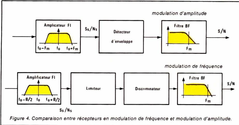
Figure 4. Comparaison entre récepteurs en modulation de fréquence et modulation d'amplitude.
