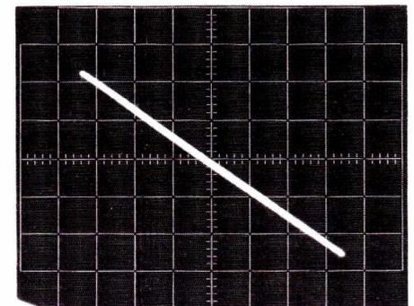
**Oscillogramme D :** L'introduction de la contre-réaction réduit fortement la distorsion de phase : l'ellipse se referme.
