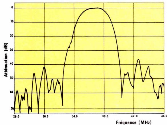
Figure 6 - Courbe amplitude/fréquence d'un filtre à onde de surface Murata, SAF 38,9 MB.
