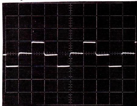
Signaux de sortie de convertisseur, chargé par des ampoules consommant 200 watts. On comparera cette figure à la suivante.
