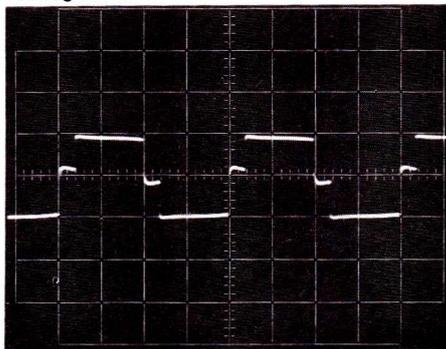
Dans les mêmes conditions que précédemment, un réglage différent de AJ2, permet de modifier l'angle d'ouverture, ici plus élevé.
