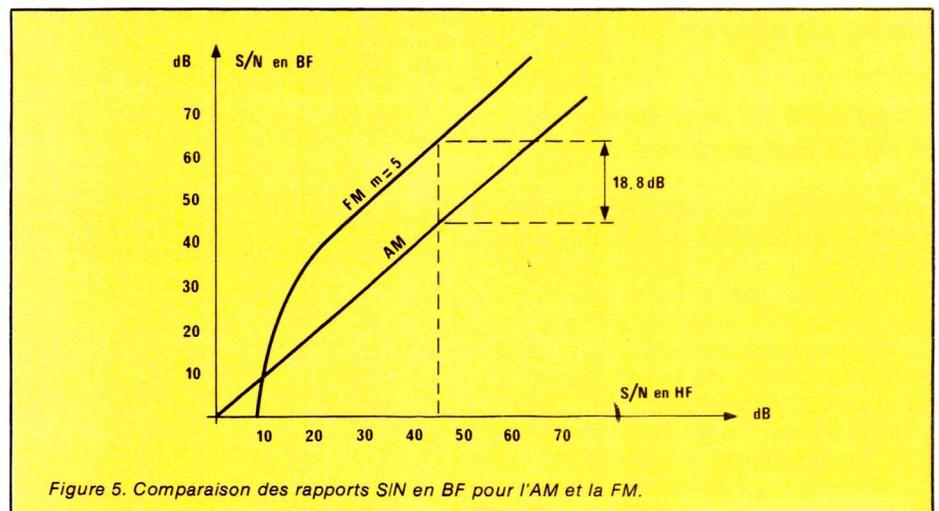
Figure 5. Comparaison des rapports S/N en BF pour l'AM et la FM.
