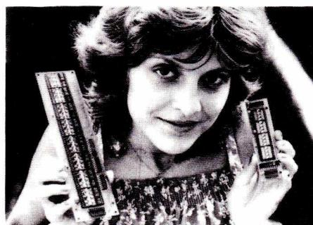
Avec la logique intégrée sur les modules, les afficheurs peuvent indiquer l'état des appareils pilotés par micro-ordinateurs et transmettre des instructions à l'utilisateur. À partir de signaux numériques simples, l'afficheur élabore de véritables messages alphanumériques, aisément lisibles. En outre, de par leur faible tension d'alimentation, 5 V seulement, ces afficheurs sont directement compatibles avec des micro-ordinateurs.
