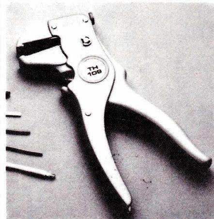
Auto-réglable, cette pince s'adapte d'elle-même sans manipulation, à tous les types de fils, massifs ou câblés, de sections allant de 0,2 mm à 6 mm<sup>2</sup>. Cependant, dans les cas où l'isolant est très tendre, une petite mollette permet de régler la pression des mâchoires sur le fil électrique. Une graduation millimétrique sur la mâchoire inférieure de la pince indique la longueur de fil à dénuder. Un coupe-câble complète l'outil.
