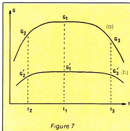
sente, en ordonnées, les variations du gain  $G$  du quadripôle seul, en fonction des fréquences portées en abscisses. On y voit que, si  $G_1$  est le gain aux fréquences moyennes, il prend des valeurs plus faibles comme  $G_2$  à une fréquence basse, et  $G_3$  à une fréquence élevée.
