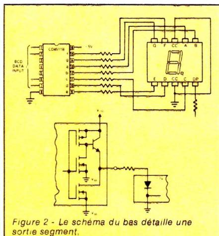
Figure 2 - Le schéma du bas détaille une sortie segment.
