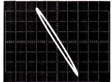
**Oscillogramme C :** Par la méthode de Lissajous, on met en évidence, sans contre-réaction, un déphasage nettement visible à l'oscilloscope : l'angle peut être estimé à une dizaine de degrés.
