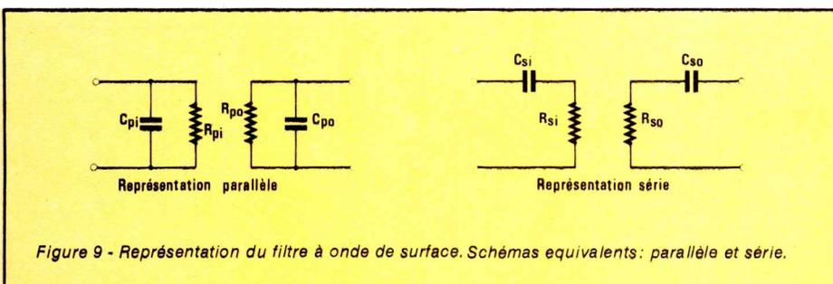
Figure 9 - Représentation du filtre à onde de surface. Schémas équivalents: parallèle et série.
