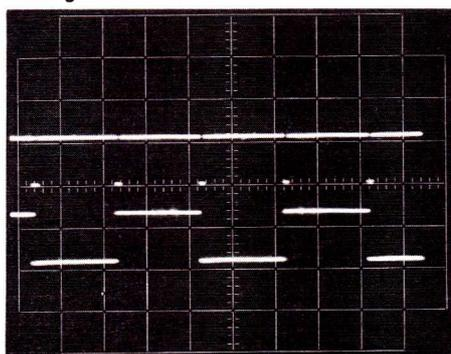
La trace supérieure donnant toujours les signaux d'horloge, on trouve maintenant, sur la trace inférieure, les crêteaux à 50 Hz obtenus après division par le bistable C3. Sensibilité verticale : 10 volts/division. Vitesse de balayage : 5 ms/division.
