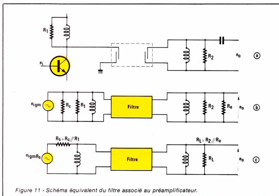
Figure 11 - Schéma équivalent du filtre associé au préamplificateur.
