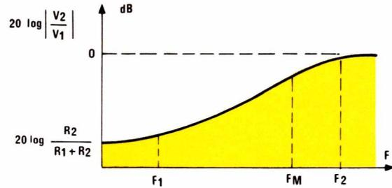
Figure 6. Réseau de préaccentuation et courbe correspondante.
