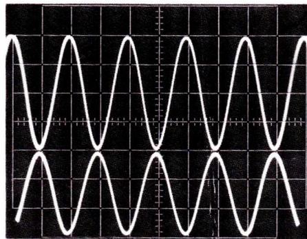
**Oscillogramme B :** L'introduction d'une contre-réaction réduit fortement la distorsion : pour une même amplitude de sortie, les sinusoïdes deviennent quasiment parfaites. En haut : 2 V/division. En bas : 1 V/division.
