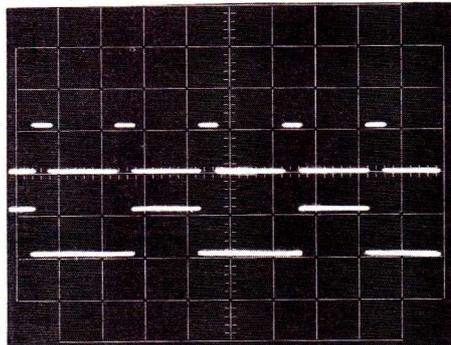
On observe ici les mêmes signaux que dans la figure précédente, mais pour un réglage différent de la résistance ajustable AJ : il est facile de voir l'influence de ce réglage sur la largeur des impulsions de commande des FET.
