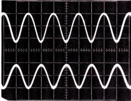
En adoptant une amplitude d'entrée, donc de sortie, suffisamment réduite pour éliminer toute distorsion visible, on peut mesurer le gain. Sans contre-réaction, on trouve ici un peu plus de 100. En haut : 2 V/division. En bas : 20 mV/division. Horizontalement : 0,5 ms/division.
