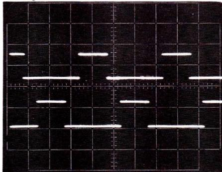
Cette figure établit la correspondance entre les signaux de commande disponibles sur les émetteurs des transistors T3 et T4.
