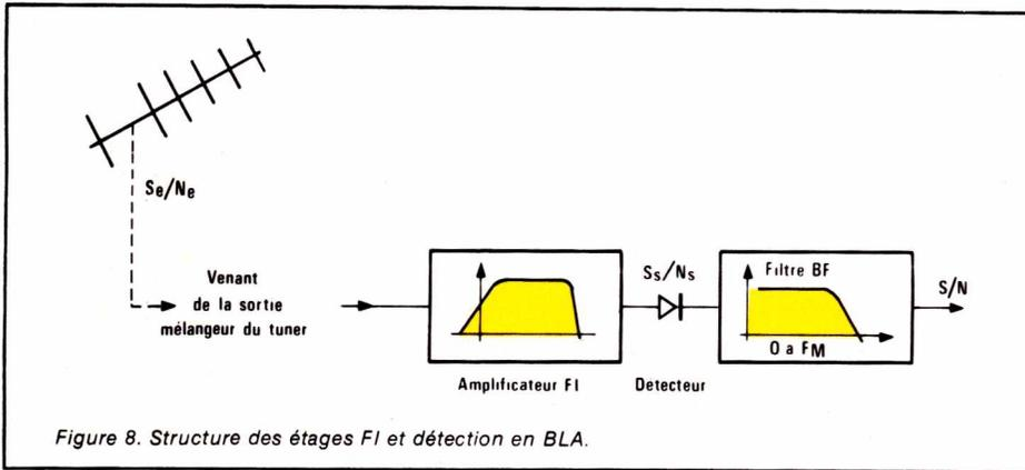
Figure 8. Structure des étages FI et détection en BLA.
