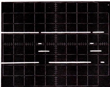
Correspondance entre les crêteaux délivrés par l'horloge, et ceux dont on dispose à la sortie du monostable C2. Sensibilité verticale : 10 volts/division. Vitesse de balayage : 5 ms/division.
