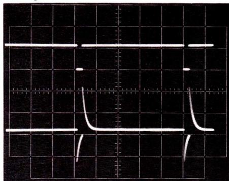
La trace supérieure montre les crêteaux de sortie de C1, à une fréquence de 100 Hz (10 volts/division). Sur la trace inférieure, on trouve les impulsions obtenues après dérivation (5 volts/division). Vitesse de balayage : 2 ms/division.
