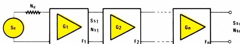
Figure 3. Mise en cascade de plusieurs étages amplificateurs réels.
