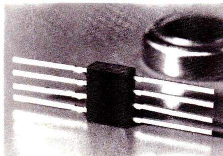
un gain en tension de 20 dB. L'autre détermine la fréquence de coupure grâce à ses passe-bas intégrés. Suivent des amplificateurs booster commandés en courant et une branche de contre-réaction portant le gain global du circuit à  $40 \text{ dB} \pm 3 \text{ dB}$ .
