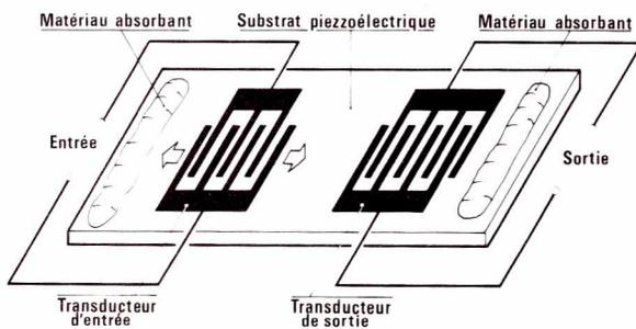
Figure 4 - Structure d'un filtre à onde de surface.
