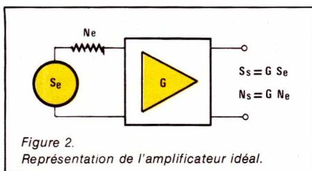
Figure 2. Représentation de l'amplificateur idéal.
