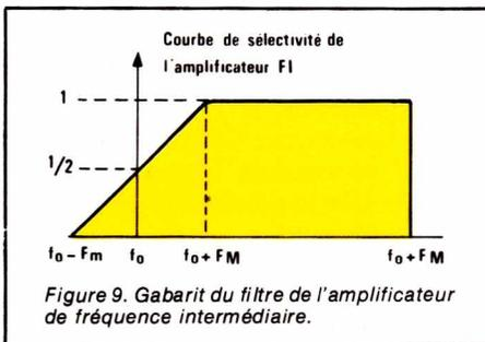
Figure 9. Gabarit du filtre de l'amplificateur de fréquence intermédiaire.
