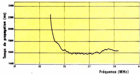
Figure 7 - Courbe temps de propagation/fréquence du filtre SAF 38,9 MB.
