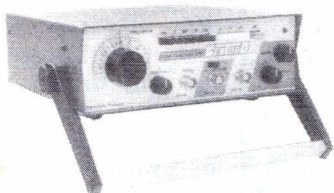
368. Générateur de fonction de 1 Hz à 200 kHz, sinus, carré, triangle, précision \pm 5\% . T.T.L. Entrée wobulation extérieure 1420F
