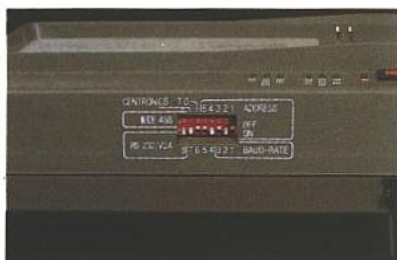
Les dipswitches de configuration du socle interface MPS.
