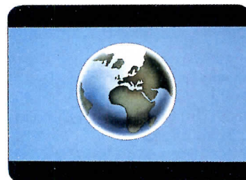
Le PAL Plus en écrans 16/9 et 4/3 (format «Letterbox» avec bandes noires de part et d'autre de l'image)
