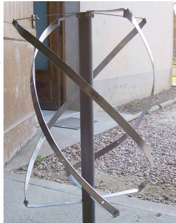
Le schéma de la QFH, demandez à F8CRM pour tout détail
