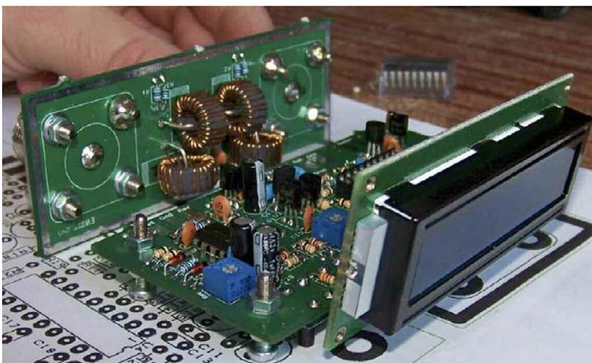
Le PIC et l'afficheur ne seront pas montés tout de suite. Il faut d'abord contrôler quelques tensions comme c'est expliqué dans la notice.
