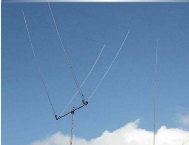
Ces antennes sont le fruit de longues expérimentations menées par Steve G0UIH. Il propose des versions DELTA LOOP mono et multi bandes sur les bandes HF.
