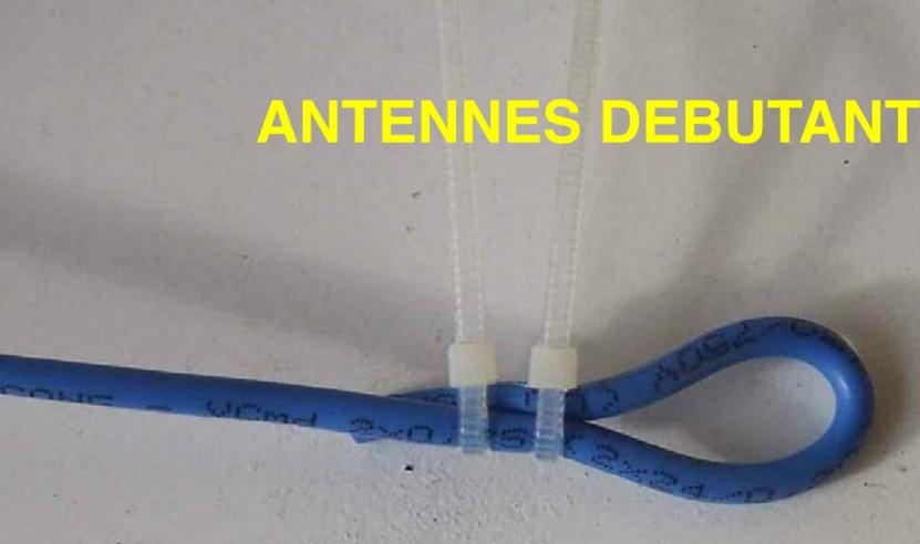
L'antenne étant un dipôle, en principe son impédance est de  $75\Omega$  en champ libre. La proximité du sol et les pertes par absorption qui en résulte font qu'elle va varier un peu. En pratique, si l'antenne est bien taillée, on aura un ROS inférieur à 2:1 sur une bande relativement large (à cause des pertes malheureusement, mais c'est une autre histoire).
