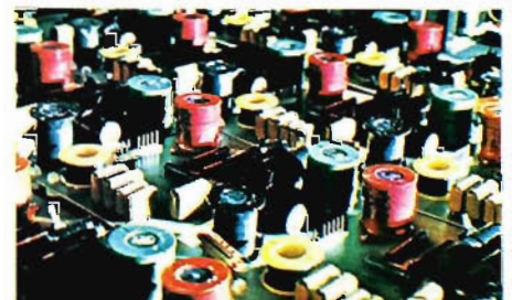
Filtres de répartition des fréquences.
