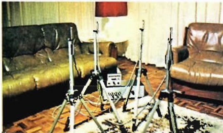
Relevé de mesures en acoustique d'appartement reconstitué.
