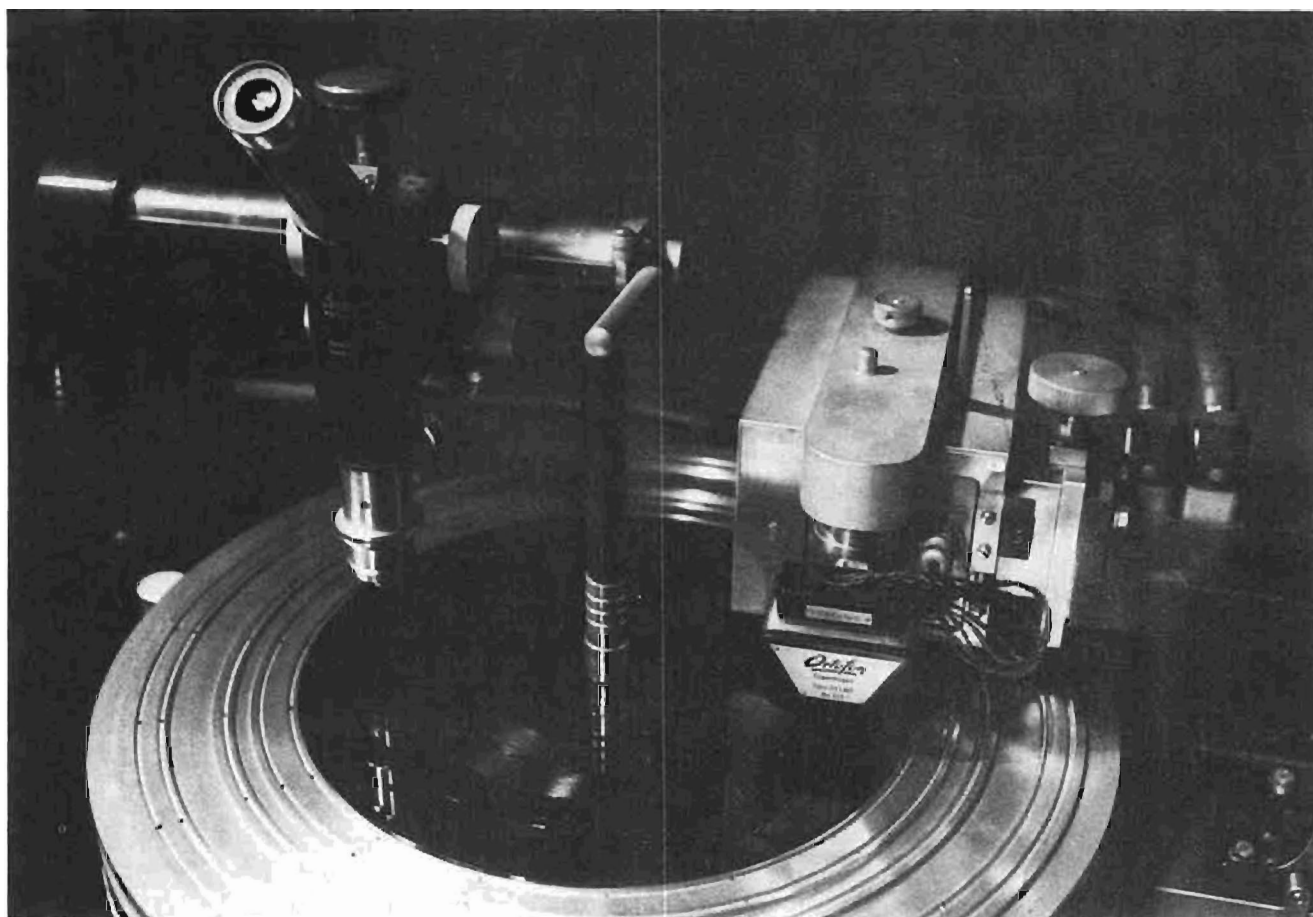
Pendant la gravure, un microscope permet de voir si tout se passe bien.
