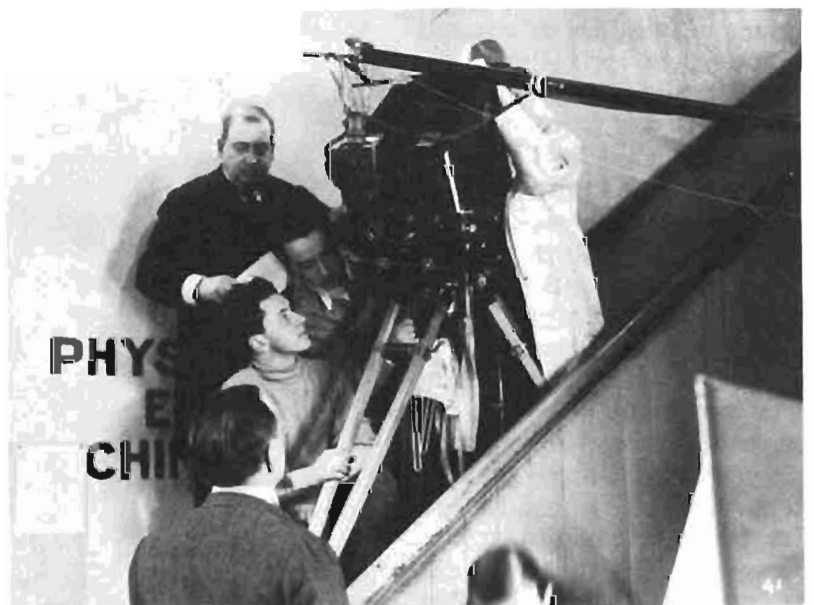
«Un plan rapproché» le micro est placé juste au dessus de l'appareil et le plus près possible de l'acteur. A noter le système d'attache monté sur un pivot. Ce bricolage permettait au «percheman» de faire pivoter le micro à droite ou à gauche tout en se déplaçant avec sa perche.
