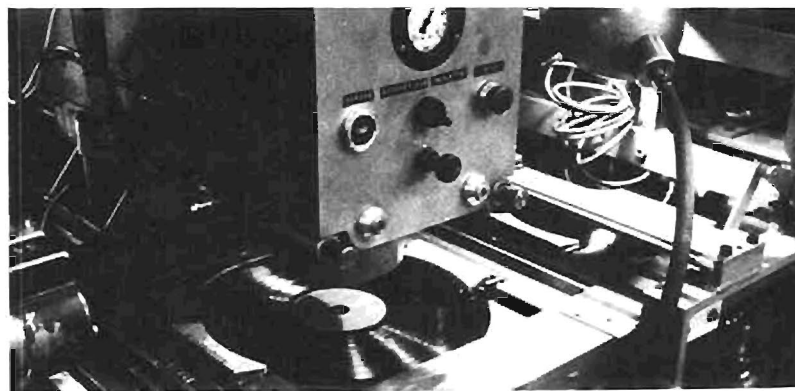
Les disques sortant des presses automatiques sont pris en charge par une machine qui imprime les étiquettes recto et verso. Ce procédé a été mis au point par la CIDIS.
