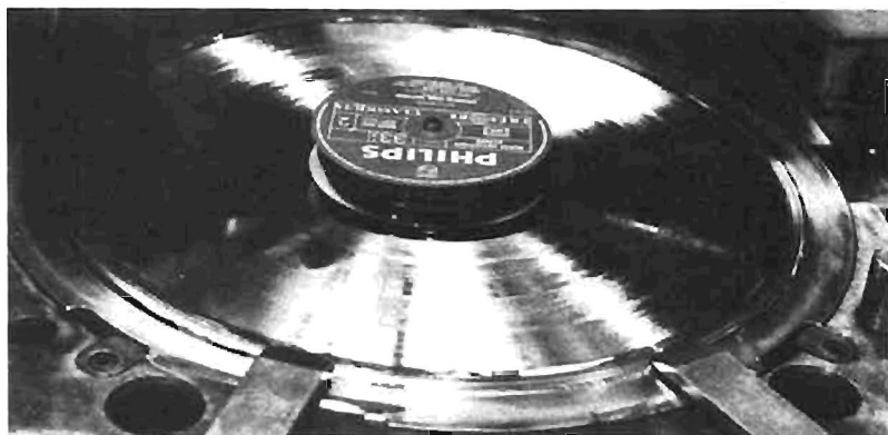
Un alignement de presses semi-automatiques. Chaque presse comporte deux postes de pressage qui permettent à la même opératrice de s'occuper de deux disques sortant alternativement de la presse.
