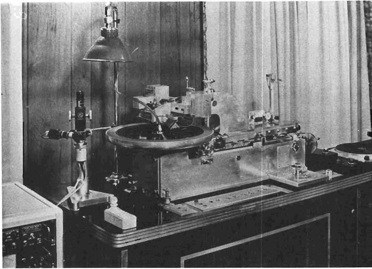
La machine de gravure : un tour d'une incroyable précision !
