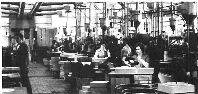
Un alignement de presses semi-automatiques. Chaque presse comporte deux postes de pressage qui permettent à la même opératrice de s'occuper de deux disques sortant alternativement de la presse.
