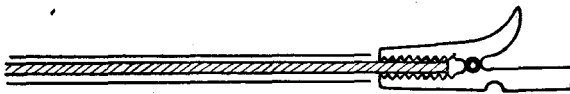
FIG. 8. — Une tige filetée de 3, taillée en pointe, recouverte d'un souplisso de 3 laissant les deux extrémités libres. Une pince crocodile prend l'extrémité non pointue. Une gaine de souplisso de 6, coulissante vient recouvrir les becs de la pince, et la bloquer en même temps pour l'empêcher de lâcher.
