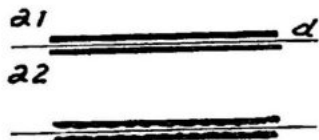
FIG. 7. — En pratiquant des rainures dans l'aluminium on augmente la surface des électrodes.
