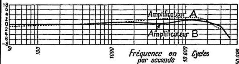
FIG. 1. — Courbe de réponse des deux amplificateurs pris isolément.
