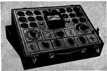
Lampemètre de service 41, le dernier-né des appareils de mesure de RADIO ELECTRICAL MEASURE, se réclame du « full floating system ».
