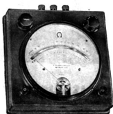
OHMMÈTRE 452 5 Sensibilités de 0,05 ohms à 50 mégohms
