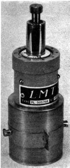
Ondmètre à cavité résonnante L.C.T. Gamme de mesure 19 à 12 cm. Précision 1/10. Coefficient de surtension 2.000 à 10.000.
