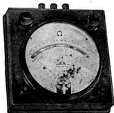
OHMMÈTRE 452 5 Sensibilités de 0,05 ohms à 50 mégohms
